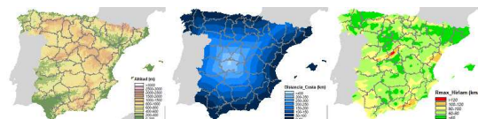
Fig. 1.- Mapas para las variables externas: elevación terreno (izq.), distancia a la costa (centro) y ejemplo de las salidas del modelo HIRLAM del campo de racha máxima (dcha.)
